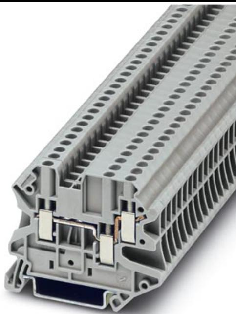
Morsetto con attacco doppio a vite su un lato, sezione: 0,14 - 2,5 mm<sup>2</sup>, spessore: 5,2 mm, colore: grigio
