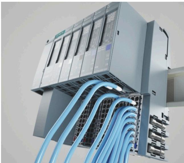
Die neue Anordnung der Klemmen und die Push-in-Klemmen machen die Verdrahtung und das Lösen der Kabel so schnell und einfach wie nie. Die Verdrahtung erfolgt ohne Werkzeug, einhändig und mit sehr geringen Einsteckkräften. Trotzdem weisen die Verbindungen eine hohe mechanische Belastbarkeit auf. Zum Lösen der Kabel wird nur ein Schraubendreher benötigt.
