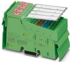
Inline, Digitalausgabeklemme, Digitale Ausgänge: 8, 24 V DC, Anschlusstechnik: 4-Leiter, Übertragungsgeschwindigkeit im Lokalbus: 500 kBit/s, Schutzart: IP20, inklusive Inline-Steckern und Beschriftungsfeldern
