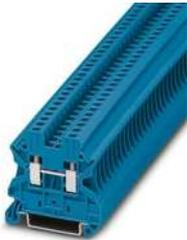
Durchgangsklemme, Nennspannung: 1000 V, Nennstrom: 24 A, Anschlussart: Schraubanschluss, Bemessungsquerschnitt: 2,5 mm<sup>2</sup>, Querschnitt: 0,14 mm<sup>2</sup> - 4 mm<sup>2</sup>, Montageart: NS 35/7,5, NS 35/15, Farbe: blau
