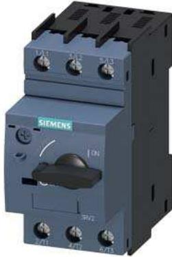
Sondertyp Leistungsschalter Baugröße S00 für den Trafoschutz A-Auslöser 7...10 A N-Auslöser 208 A Schraubanschluss Standardschaltvermögen Umgebungstemperatur -50 °C 500 Schaltspiele
