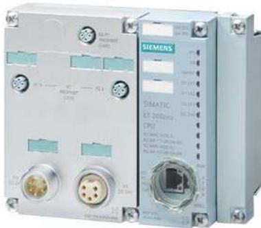
SIMATIC DP, CPU 1513pro-2 PN für ET 200pro, Zentralbaugruppe mit Arbeitsspeicher 300 KB für Programm und 1,5 MB für Daten, 1. Schnittstelle: PROFINET IRT mit 3 Port Switch, 2. Schnittstelle: PROFINET RT, 40 NS Bit-Performance, Schutzart: IP65/67, SIMATIC Memory Card notwendig Anschlussmodul notwendig
