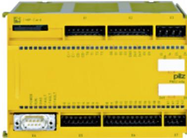
Konfigurierbare sichere Kleinststeuerungen PNOZmulti Classic, Basisgerät, nicht erweiterbar (Linkmodule, 1 Felbusmodul anschließbar), serielle Schnittstelle RS232, 20 sichere digitale Eingänge, 4 sichere Halbleiterausgänge, 2 sichere Relaisausgänge.
