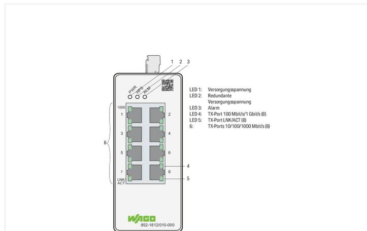
Der 852-1812/010-000 ist ein industrieller, konfigurierbarer ETHERNET-Switch mit 8 Ports 10/100/1000BASE-T.
