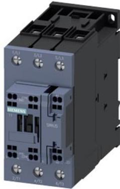
Leistungsschütz, AC-3 40 A, 18,5 kW / 400 V 1 S + 1 Ö, AC / DC 175-280 V, mit Varistor, 3-polig, Baugröße S2, Federzuganschluss
