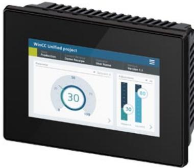
SIMATIC HMI MTP700, Unified Comfort Panel, Neutral, Touchbedienung, 7" Widescreen-TFT-Display, 16 MIO Farben, PROFINET Schnittstelle, projektierbar ab WinCC Unified Comfort V16, enthält Open Source SW, die unentgeltlich überlassen wird siehe beiliegende DVD
