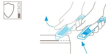
Daumen hoch – für eine hohe Sicherheit. Sobald Sie mit dem Schneiden beginnen, lassen Sie den Schieber los. So verschwindet die Klinge nach dem Schnitt sofort wieder im Griff.
