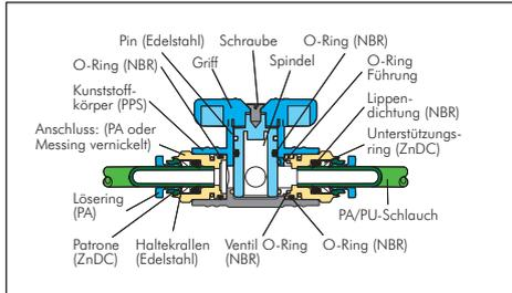
**Werkstoffe:** Körper: Messing vernickelt/PA 66/PPS, Dichtung: NBR, Haltekralle: Edelstahl, Patrone: ZnDC vernickelt, Lösering: PA 66 (bei der Montage werden ausschließlich silikonfreie Dichtungen und Schmierstoffe verwendet)
