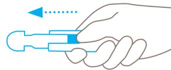
**Drücken** Sie den Kunststoffeinsatz mithilfe des Schiebers nach hinten heraus. Nicht am Einsatz ziehen und gleichzeitig den Schieber festhalten.
