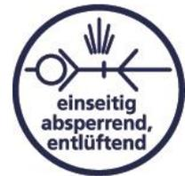
**Schwenk-Sicherheitskupplung NW 7,2, Außengewinde**
