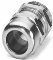
Kabelverschraubung, Material Verschraubung: Messing, vernickelt, Kabelaußendurchmesser 4 mm ... 8 mm, Schirmung: nein, Anschlussgewinde: M16 x 1,5, Farbe: silberfarben, mit O-Ring
