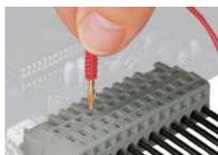
Prüfen – Federleiste mit CAGE CLAMP®-Anschluss
