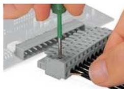
Leiter anschließen – Betätigung des CAGE CLAMP®-Anschlusses mit Schraubendreher (Klingenbreite 3,5 mm) – rechtwinklig zur Leiteranschlußrichtung.
