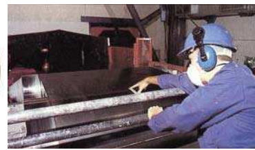
Indikatoren im Einsatz zur Prüfung der Aushärte-Temperatur bei der Stahlband-Produktion.
