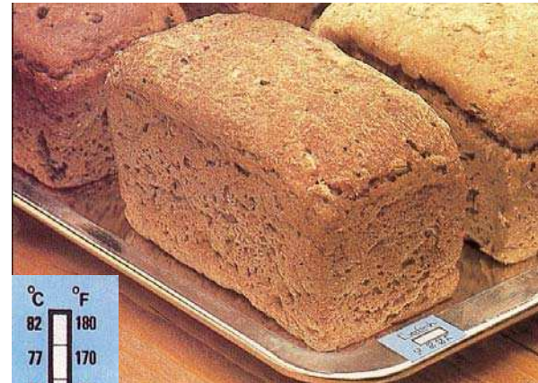
3-Punkte-Messstreifen im Einsatz zwecks Prüfung der Back-Temperatur
