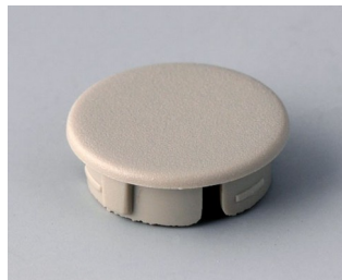
A4116007 Deckel 16, ohne Strich ABS (UL 94 HB) kieselgrau RAL 7032
