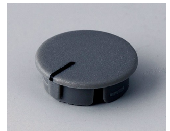
A4116108 Deckel 16, mit Strich ABS (UL 94 HB) staubgrau RAL 7037
