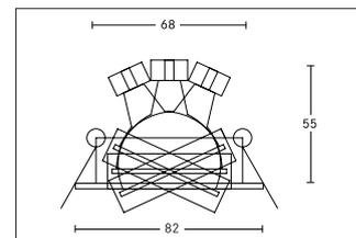
Deckeneinbauleuchte, chrom. Ausgeführt in kompakter Bauform für werkzeuglose Schnellmontage zum Deckeneinbau. Fassung: GX5,3, Montageart: Einbaumontage, Montageort: Deckenmontage, Schutzart: nach DIN EN 60529: IP20, Schutzklasse: (EN 61140) III, Spannung: 12V, Leistung: max. 50W, ohne Betriebsgerät, Art der Dimmung: sonstige.
