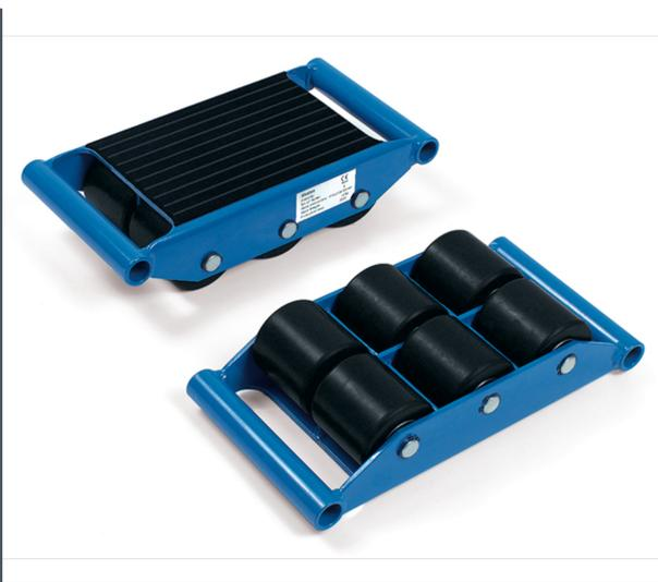
Für den leichten und sicheren Transport von schweren Gegenständen wie Behälter, Kisten, Maschinen usw. Stabile Stahl-Schweißkonstruktion, mit Handgriffen aus Rundstahl oder Stahlrohr, pulverbeschichtet blau RAL 5007. Tragplatten mit rutschhemmender Gummiauflage versehen. Große Nylonrollen kugelgelagert. Hohe Tragkraft bei geringem Eigengewicht. Rollengröße Ø x Breite 85x85 mm. Lieferumfang: 1 Stück
