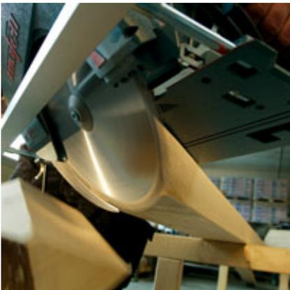
Ideal für Schifterschnitte: die MKS 130 Ec kann bis 60° geneigt werden. Die maximale Schnitttiefe beträgt dann immer noch enorme 65 mm.
