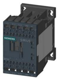
CONTACTOR, AC-3, 5.5KW/400V, 1NO, AC 24V, 50/60 HZ, 3-POLE, SZ S00 SPRING-LOADED TERMINAL
