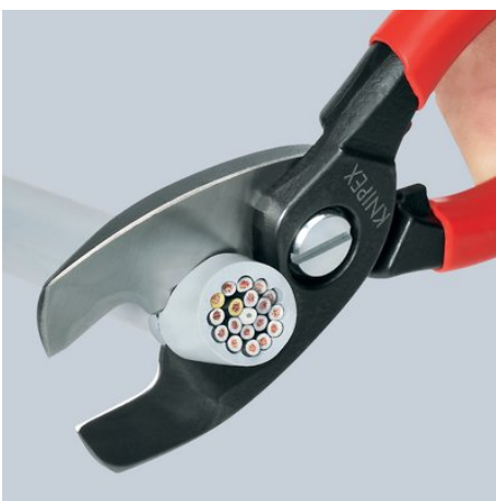
Cięcie ostateczne: jeżeli do przecięcia kabla wymagana jest większa siła, można użyć ostrza znajdującego się w pobliżu złącza nożyc. Cięcie wstępne za pomocą ostrza przedniego - cięcie ostateczne za pomocą ostrza tylnego
