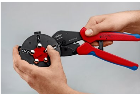
Krimpprofiel vervangen: magazijn ontgrendelen, krimpprofiel uit de tang nemen
