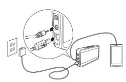
Versorgen Sie bei Verwendung eines Smartphones die Freisprechanlage mit Strom, indem Sie entweder das enthaltene USB-Kabel an einen Computer oder das Smartphone-Netzteil mit USB-Schnittstelle (nicht im Lieferumfang enthalten) an eine externe Stromversorgung anschließen.
