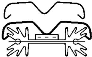
Profilkühlkörper und Flüssigkeitskühlkörper>Transistorhaltefedern
