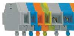
Klemmenleiste mit Rastfüßen, für Blechdicke 0,6 ... 1,2 mm, Befestigungslöcher Ø 3,5 mm (auch auf Alu-Schiene (210-154) oder mit Montagefuß (209-120) auf Tragschiene 35)
