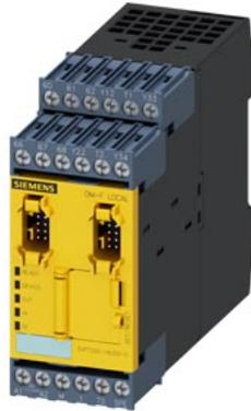
fehlersicheres Digitalmodul DM-F local, zur fehlersicheren Abschaltung über Hardware-Signal US: 110...240 V AC/DC 2 Relais-Freigabekreise, 2 Relais-Ausgänge, Sicherheitsfunktion über DIL-Schalter einstellbar, max. erreichbarer SIL IEC 61508: 3, max. erreichbarer PL ISO 13849-1: E
