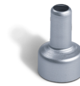
Reduzierdüse Ø 7 mm erhöht die Temperatur auf 500°C zur punktuellen Erwärmung
