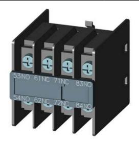
AUX.SWITCH BLOCK,FRONT,2NO+2NC, CURR.PATH: 1NO, 1NC, 1NC, 1NO, FOR CONTACTOR RELAYS, SZ S00, RING CABLE LUG CONNECTION 53 / 54,61 / 62,71 / 72,83 / 84
