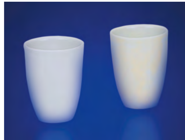
Tiegel eines Wettbewerbers vor (links) und nach (rechts) der thermischen Behandlung, mit deutlichen Verfärbungen der Glasur nach Erstanwendung.
