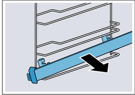
5. Die Auszugsschiene reinigen.
