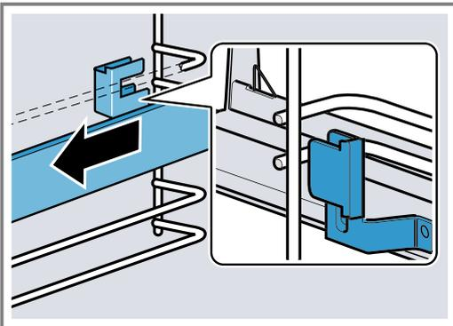
4. Die Auszugsschiene entfernen.
