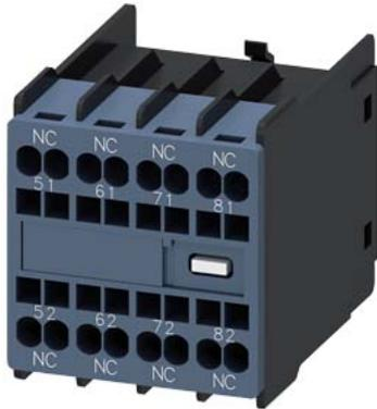
Hilfsschalter, frontseitig, 4 Ö, 51/52, 61/62, 71/72, 81/82, Strombahn: 1 Ö, 1 Ö, 1 Ö, 1 Ö, Federzuganschluss, physisch kodiert, nur mit Hilfsschützen 3RH2140 und 3RH2440 kombinierbar (nach EN 50011)
