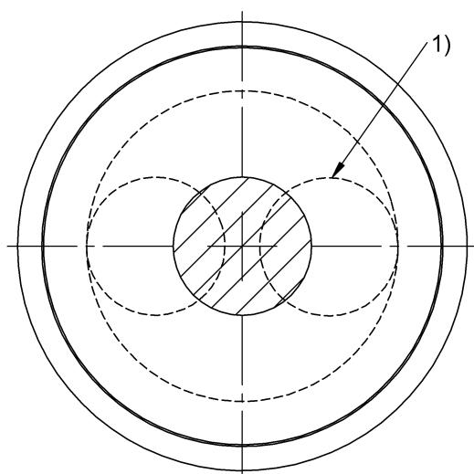
1) Kabelabgang exzentr. möglich
