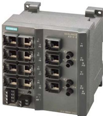
SCALANCE X212-2, managed IE Switch, 12x 10/100 Mbit/s RJ45 Ports, 2x 100 Mbit/s Multimode BFOC, LED-Diagnose, Fehlermelde- Kontakt mit Set-Taster, redundante Spannungsversorgung, PROFINET IO Device, Netzwerk-Management, Redundanz-Manager integriert, inkl. elektron. Handbuch auf CD-ROM, C-PLUG optional.
