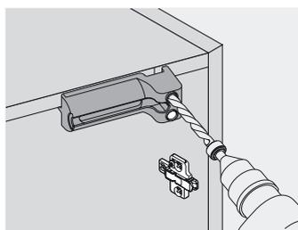
Bohrung für BLUMOTION mit Bohrer Ø 10 mm anbringen
