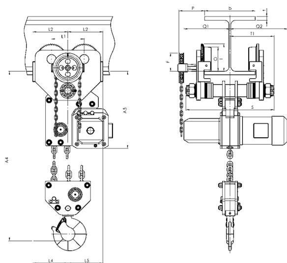
CPEF<sup>1</sup>/CPEF Festverbindung mit Haspel- oder Elektrofahrwerk, 7.500 kg
