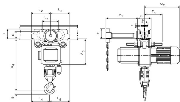
CPEF<sup>1</sup>/CPEF Festverbindung mit Haspelfahrwerk
