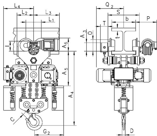
CPEF<sup>1</sup>/CPEF Festverbindung mit Elektrofahrwerk, 10.000 kg
