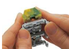
Klemmenleiste mit Rastfüßen Anrasten des Montagefußes (209-120) (Der Abstand der Montagefüße zueinander unter einer Klemmenleiste soll ca. 25 ... 30 mm betragen.)
