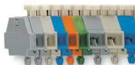
Klemmenleiste mit Rastfüßen, für Blechdicke 0,6 ... 1,2 mm, Befestigungslöcher Ø 3,5 mm (auch auf Alu-Schiene (210-154) oder mit Montagefuß (209-120) auf Tragschiene 35)
