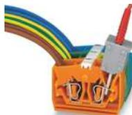
Prüfen über CAGE CLAMP®-Anschluss an der Stromschiene – möglicher Nennstrom 6 A; Durch CAGE CLAMP®-Betätigung können einzelne Prüfkontakte geklemmt werden. Die maximale Prüfspannung beträgt 400 V.
