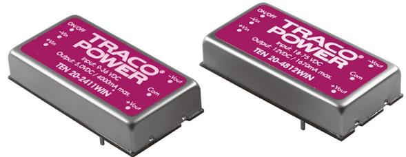
Die TEN 20WIN Serie bietet sehr leistungsfähige 20 W DC/DC-Konverter bei einem sehr weiten 4:1 Eingangsbereich in einem ultrakompakten 2" x 1" Gehäuse mit Industriestandard Pin-Out. Der sehr hohe Wirkungsgrad ermöglicht einen Arbeitstemperaturbereich von  $-40\text{ °C}$  bis  $+85\text{ °C}$ . Weitere Merkmale sind die externe Ein/Aus-Funktion, die einstellbare Ausgangsspannung, Überspannungsschutz sowie die Dauerkurzschlussfestigkeit.
