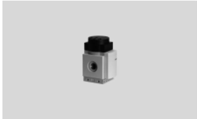
Die Dauer des Druckaufbaus wird über die am Ventildeckel angebrachte Drossel eingestellt. Entsprechend der eingestellten Drosselstellung steigt der Ausgangsdruck p2 langsam an. Bei Erreichen des Durchschaltendrucks öffnet der Hauptsitz.
