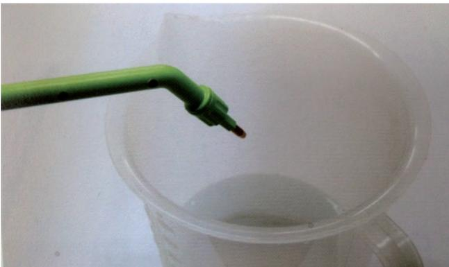
3- Conecte la limpiadora a la corriente y coloque la boquilla del vapor en algún depósito o drenaje.
