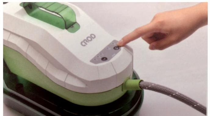
6- Cuando se completa la limpieza, pulse el botón cooling/stop (enfriar/detener) para enfriar la máquina unos 20-30 segundos mientras descarga el agua. Pulse el botón cooling/Stop (enfriar/detener) para terminar el enfriamiento. Desconecte el equipo y saque el agua de la máquina abriendo el tapón de drenaje en el fondo de la limpiadora.
