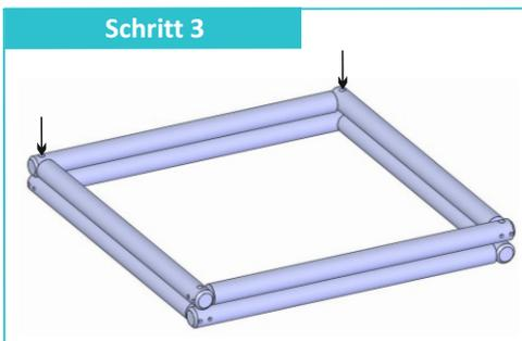
Legen Sie das letzte Seitenteil an und gehen ebenfalls vor wie in Schritt 1. Stecken Sie die Gewindestange von oben durch die Bohrung und ziehen diese mit je 2 U-Scheiben und je 2 Muttern an.
