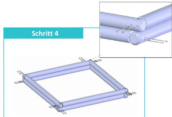
Verschrauben Sie nun die Seitenteile durch die vorgebohrten Löcher an jeder Ecke mit je 2 Schrauben (Spax TX 10 x 200mm). Achten Sie darauf das alle Seitenteile in einem 90 Grad Winkel zueinander stehen.
