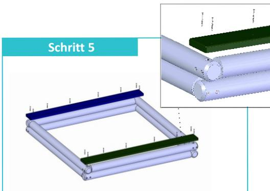
Legen Sie die Sitzauflagen entsprechend der Skizze auf die Seitenteile auf. Verschrauben Sie anschließend die Sitzauflagen durch die vorgebohrten Löcher mit den Seitenteilen von oben mit je 8 Schrauben (Spax TX 6x80mm). Achten Sie bei der Montage der Sitzauflagen darauf, dass die abgerundeten Kanten nach oben zeigen.
