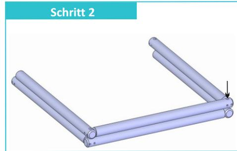
Legen Sie das nächste Seitenteil an und gehen Sie vor wie in Schritt 1. Stecken Sie die Gewindestange von oben durch die Bohrung und ziehen diese mit 2 U-Scheiben und 2 Muttern an.
