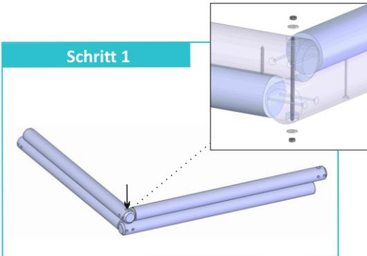
Legen Sie die Seitenteile auf einer ebenen Unterlage aus und richten Sie diese in einem 90 Grad Winkel aus. Stecken Sie die Gewindestange von oben durch die Bohrung und ziehen diese mit 2 U-Scheiben und 2 Muttern an.
