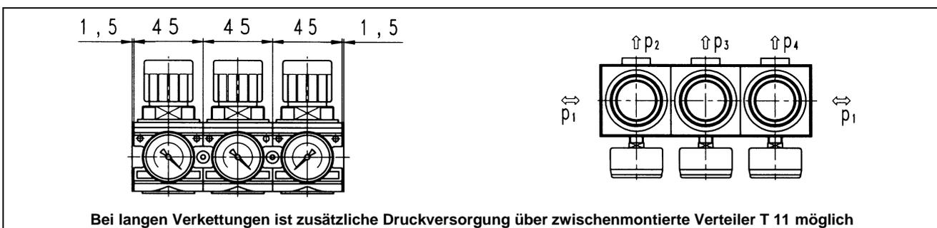
Bei langen Verkettungen ist zusätzliche Druckversorgung über zwischenmontierte Verteiler T 11 möglich
