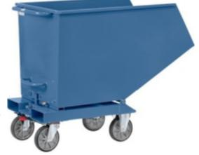
800 kg Kastenma sse: L 1321 x B 1044 x H 735 mm Au ssenma sse: L 1458 x B 1105 x H 1099 mm Schüttkantenhöhe: 843 mm Eigengewicht: 118 kg Hinweis: Kippvorgang wird manuell ausgelöst. Für die Entleerung mit dem Gabelstapler oder bei schwerer Beladung empfehlen wir einen Kippbehälter oder Stapelkipper.
