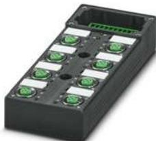
Sensor-/Aktor-Box-Grundgehäuse, Anwendung: Standard, Anschlussart: M12-SPEEDCON-Buchse Metall, Anzahl der Steckplätze: 8, Polzahl: 5, Kodierung: A - Standard, Steckplatzbelegung: doppelt, Statusanzeige: Ja, pnp; Stammleitungsanschluss: Steckbarer Schraubanschluss, Schirmung: nein
