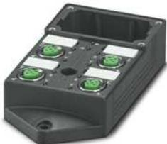
Sensor-/Aktor-Box-Grundgehäuse, Anwendung: Standard, Anschlussart: M12-SPEEDCON-Buchse Metall, Anzahl der Steckplätze: 4, Polzahl: 5, Kodierung: A - Standard, Steckplatzbelegung: doppelt, Statusanzeige: Ja, pnp; Stammleitungsanschluss: Steckbarer Schraubanschluss, Schirmung: nein
