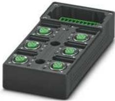
Sensor-/Aktor-Box-Grundgehäuse, Anwendung: Standard, Anschlussart: M12-SPEEDCON-Buchse Metall, Anzahl der Steckplätze: 6, Polzahl: 4, Kodierung: A - Standard, Steckplatzbelegung: einfach, Statusanzeige: Ja, pnp; Stammleitungsanschluss: Steckbarer Schraubanschluss, Schirmung: nein
