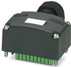
Anschlusshaube mit integriertem Steckverbinder mit Schraubanschluss, für Sensor-/Aktor-Boxen mit M12-Metallgewinde oder QUICKON-Anschluss und steckbaren Stammleitungsanschluss, für 4, 6 oder 8 Steckplätze
