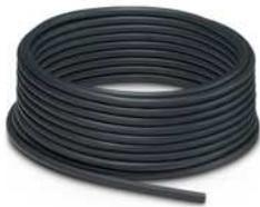
Stammleitung für Sensor-/Aktor-Boxen, mit PE-Leiter, ungeschirmt, Material PUR/PP, 19-polig, 16 x 0,50 mm<sup>2</sup> und 3 x 1,00 mm<sup>2</sup>, Länge: 50 m
