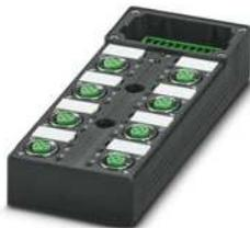
Sensor-/Aktor-Box-Grundgehäuse, Anwendung: Standard, Anschlussart: M12-SPEEDCON-Buchse Metall, Anzahl der Steckplätze: 8, Polzahl: 4, Kodierung: A - Standard, Steckplatzbelegung: einfach, Statusanzeige: Ja, pnp; Stammleitungsanschluss: Steckbarer Schraubanschluss, Schirmung: nein
