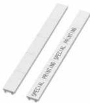
Schützschild-Zackband, bestellbar: streifenweise, gelb, beschriftet nach Kundenangaben, Montageart: verrasten in flacher Schildchennut, für Klemmenbreite: 17,5 mm, Schriftfeldgröße: 17,5 x 9 mm
