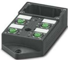
Sensor-/Aktor-Box-Grundgehäuse, Anwendung: Standard, Anschlussart: M12-SPEEDCON-Buchse Metall, Anzahl der Steckplätze: 4, Polzahl: 4, Kodierung: A - Standard, Steckplatzbelegung: einfach, Statusanzeige: Ja, pnp; Stammleitungsanschluss: Steckbarer Schraubanschluss, Schirmung: nein
