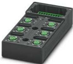
Sensor-/Aktor-Box-Grundgehäuse, Anwendung: Standard, Anschlussart: M12-SPEEDCON-Buchse Metall, Anzahl der Steckplätze: 6, Polzahl: 5, Kodierung: A - Standard, Steckplatzbelegung: doppelt, Statusanzeige: Ja, pnp; Stammleitungsanschluss: Steckbarer Schraubanschluss, Schirmung: nein
