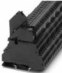
Sicherungsreihenklemme, Art der Sicherung: Glas / Keramik / ..., Sicherungstyp: G / 5 x 20, Nennspannung: 400 V, Nennstrom: 32 A, Polzahl: 1, Anschlussart: Schraubanschluss, Bemessungsquerschnitt: 4 mm<sup>2</sup>, Querschnitt: 0,2 mm<sup>2</sup>- 4 mm<sup>2</sup>, Anschlussart: Schraubanschluss, Bemessungsquerschnitt: 1 mm<sup>2</sup>, Querschnitt: 0,2 mm<sup>2</sup>- 4 mm<sup>2</sup>, Montageart: NS 35/7,5, NS 35/15, NS 32, Farbe: schwarz
