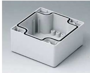
C2080802 Gehäuseschale 80, mit Dichtung PC (UL 94 HB) lichtgrau RAL 7035 80x80x40mm
