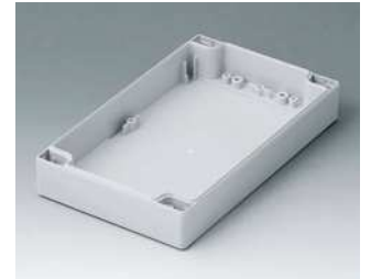
C0122002 Gehäuseschale 120, mit Feder PC (UL 94 HB) lichtgrau RAL 7035 200x120x30mm
