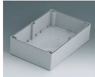
C5203001 Gehäuseschale 200, mit Dichtung ABS (UL 94 HB) lichtgrau RAL 7035 300x200x80mm
