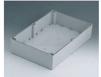
C5243601 Gehäuseschale 240, mit Dichtung ABS (UL 94 HB) lichtgrau RAL 7035 360x240x80mm
