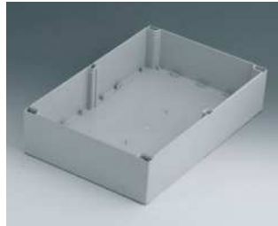
C4243601 Gehäuseschale 240, mit Feder ABS (UL 94 HB) lichtgrau RAL 7035 360x240x80mm
