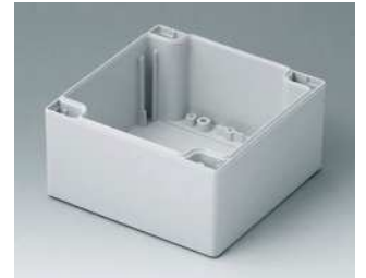
C2121201 Gehäuseschale 120, mit Feder ABS (UL 94 HB) lichtgrau RAL 7035 120x120x60mm
