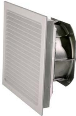
Filterlüfter, Ausschnitt: B: 292 mm, H: 292 mm, RAL 7032, IP54, Luftstrom: 580 m<sup>3</sup>/h, Ue AC: 230 V
