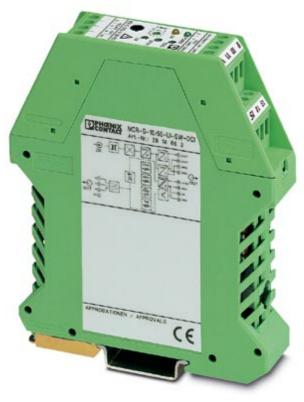
MCR-Strommessumformer, programmierbar und konfigurierbar, zur Messung von Gleich-, Wechsel- und verzerrten Strömen, Eingangsstrom 0...10 bis 0...50 A , unkonfiguriert
